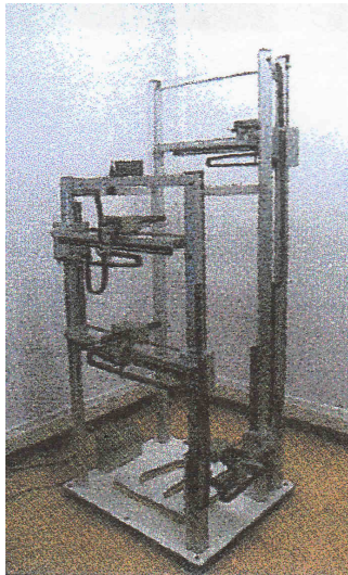
Figuur 7 Door Koelman en Plomp ontwikkelde 3-dimensionale bekkenmeter.
